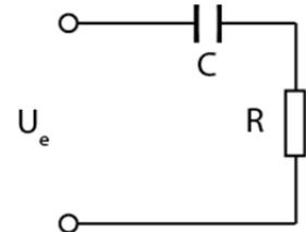
Bei Anlegen einer Gleichspannung stellt man durch Messung des durch die Spannungsquelle gelieferten Stromes einen Widerstand von  $50 \Omega$  fest, bei Anlegen einer Wechselspannung mit einer Frequenz von  $50 \text{ Hz}$  einen Widerstand von  $20 \Omega$ . Entscheiden Sie, welche der drei gezeigten Konfigurationen vorliegt und berechnen Sie die Werte für  $R$  und  $C$ .
